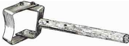
Fig. 15.- Barrasquillo para el método de pica de corteza
