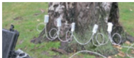
El tomógrafo sónico es el equivalente a un "escaner" o "ecografía" del árbol.
