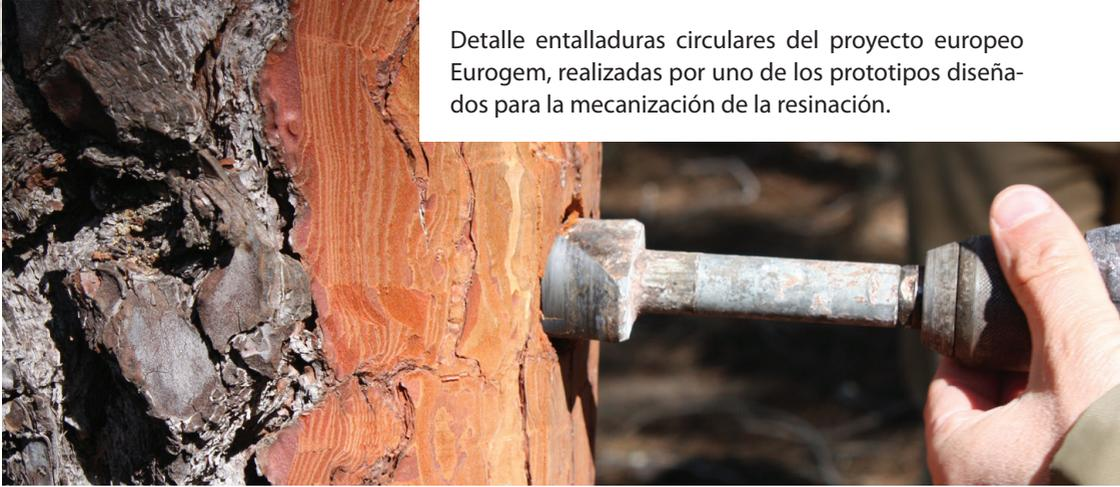
Detalle entalladuras circulares del proyecto europeo Eurogem, realizadas por uno de los prototipos diseñados para la mecanización de la resinación.
